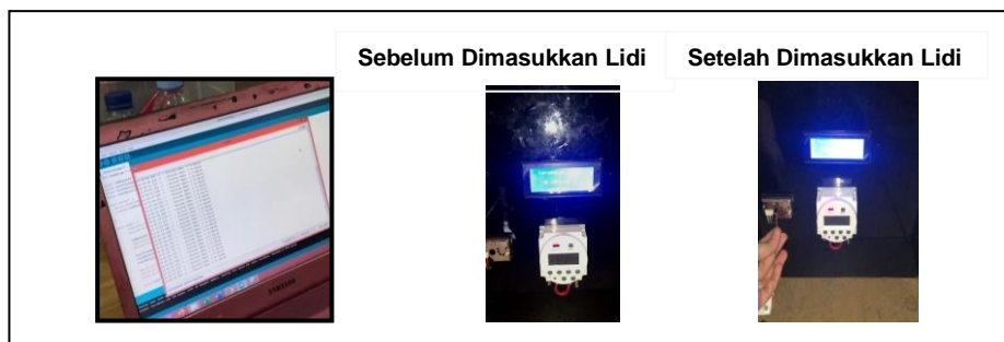
Gambar 9. Pengujian Sensor GP2Y1010AU0F
