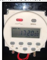
Gambar 12. Pengujian Saklar Timer Otomatis
